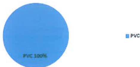
Podíl délek potrubí vodovodu Světlice-zdroj dle materiálu
